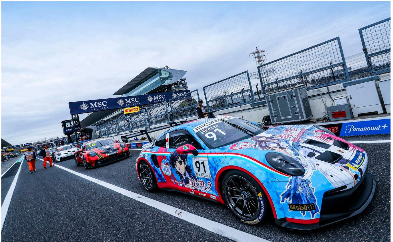
世界最速のワンメイクレースシリーズとして世界各地で開催されているポルシェカレラカップ。日本国内では2001年から開催されており、今年で24年目を迎えるPCCJは、国内におけるワンメイクレースとしてもっとも長い歴史を誇り、昨年開催200戦を迎えた。レース車両は導入3年目となる「911 GT3カップ (タイプ992)」で、ドライサンプ潤滑方式を備えた高回転ユニットの水冷式4L水平対向6気筒エンジンを搭載し、8400rpmで最高出力375kW(510PS)を発揮する。ワイドながら軽量のターボ仕様のボディを採用し、空力パフォーマンスに優れたスワンネックタイプの大型リアウイングを備えている。
